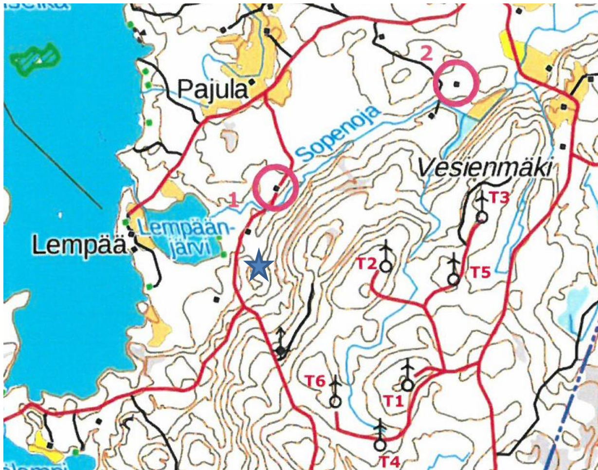
Kuva 26. Luhangan Latamäen tuulivoima-alue [13]. Kuusi Vestas V112-3.0 MW tuulivoimalaa, joiden napakorkeus on 140 m ja roottorin halkaisija 112 m. Sisämelun mittauspisteestä (merkitty sinisellä tähdellä) likimain suoraan itään sijaitsevien tuulivoimaloiden T2 ja T5 tornien välinen etäisyys on noin 500 m ja lähimmän voimalan tornin etäisyys sisämelun mittauspisteestä noin 1060 m. Ulkomelumittauksia tehtiin punaisella ympyrällä merkityssä mittauspisteessä 2.
