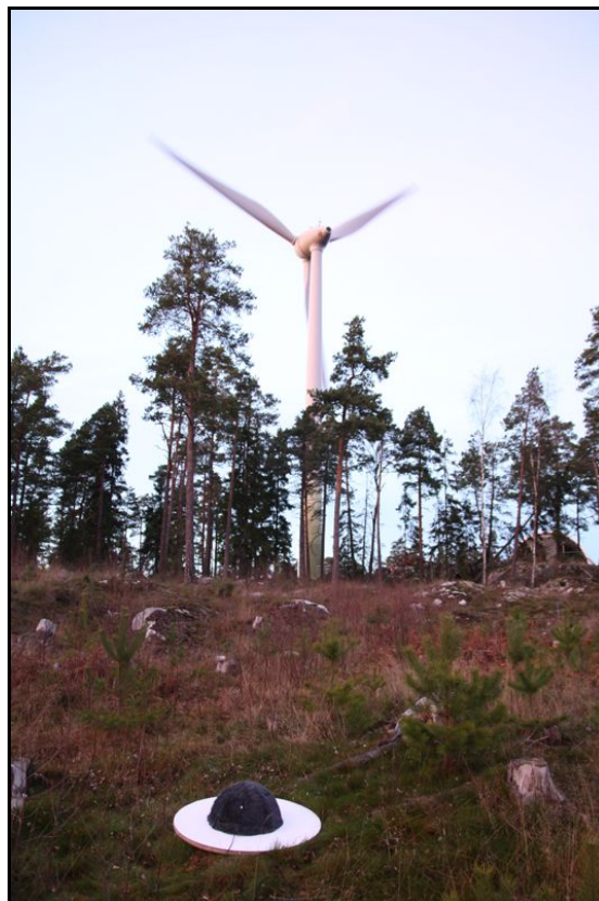
Kuva 3. Äänitehotasomittauspisteet LW 2. ja 3.mittauksen aikana. Mittauslauta ja tuulisuojakupu kuvan alalaidassa, myötätuulimittaus.
