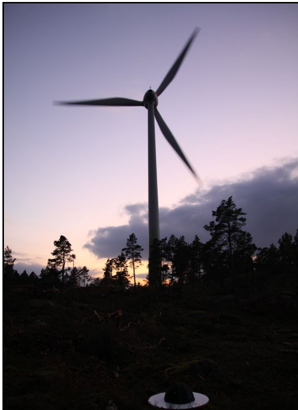
Kuva 3. Äänitehotasomittauspisteet LW 2. ja 3.mittauksen aikana. Mittauslauta ja tuulisuojakupu kuvan alalaidassa, myötätuulimittaus.
